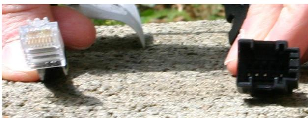
Voraussetzung für den Anschluss an den Mercedes internen Datenbus ist eine entsprechende Ausrüstung des Fahrzeugs (Datenfunkvorrüstung). Der Anschluss an den RS485 Bus des Fahrzeugs erfolgt mit dem Adapterkabel Bestellnummer 4580 an der Westernbuchse DATA 2 der S-Box.
