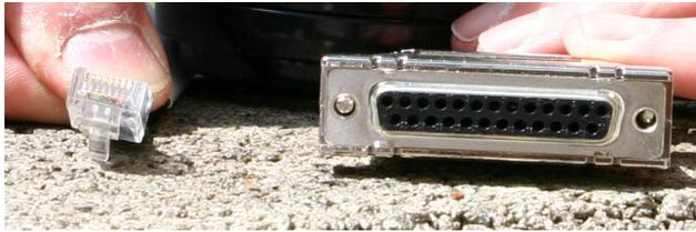
8 poligen Western Stecker (S-System Anschluss). Das Display wird über dieses Kabel mit Spannung versorgt. Das S-System wird über das 80T1 Display ein- und ausgeschaltet.
